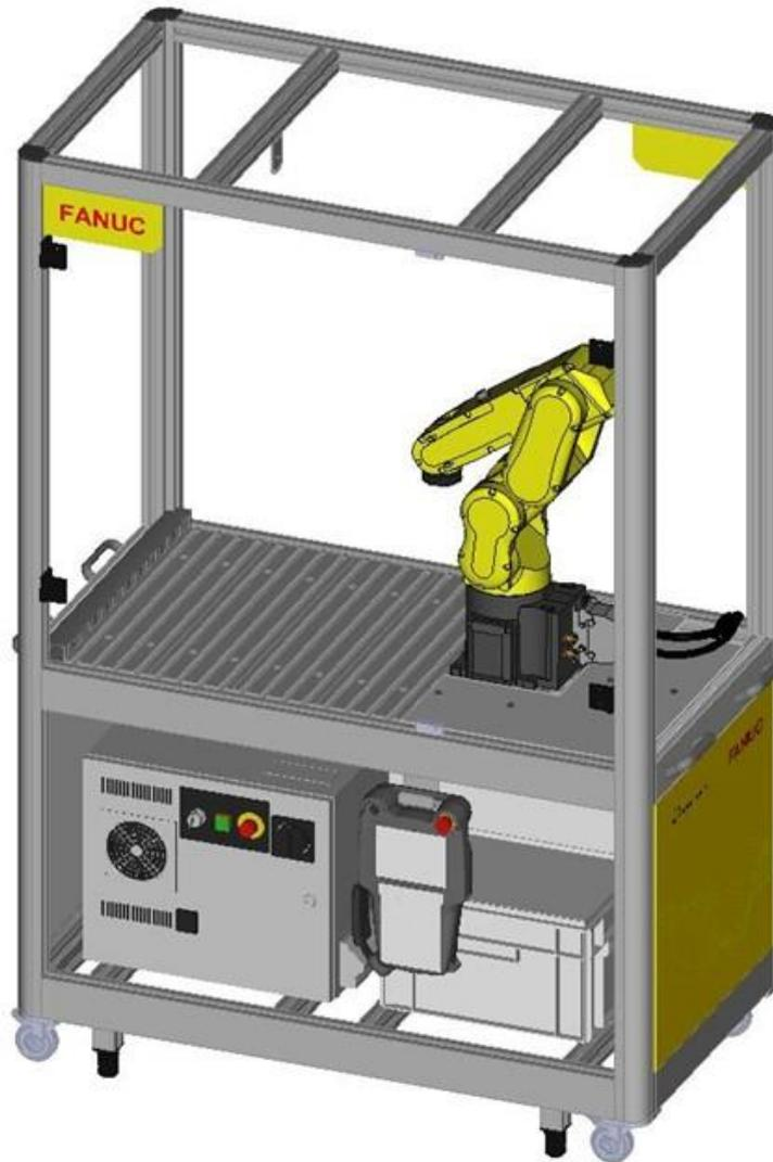
La célula educativa se entrega “lista para funcionar”- no hay necesidad por parte de los competidores de instalar físicamente el robot y conectarlo a la corriente.
