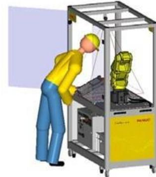
Mientras se instalan, conectan los periféricos etc. la corriente del Servo debe ser cortada mediante el E-stop en el Teach-Pendant o en el controlador.
