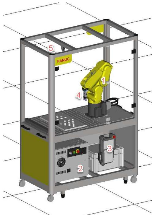
La celda educativa que se va a emplear en la competición utiliza el robot FANUC ER-4iA junto con el controlador R-30iB Mate Plus de última generación. El robot está equipado con un sistema de cámara 2D iRVision integrado y una pinza Schunk EGP40.
